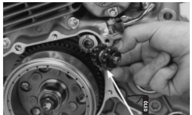
ENGRENAGEM DE REDUÇÃO DE PARTIDA/ARRUELAS JUNTA
