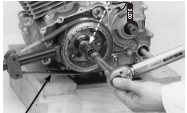
FIXADOR DO VOLANTE DO MOTOR
